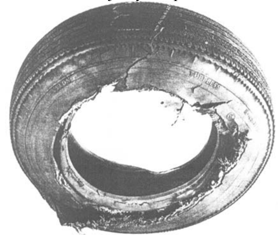
Rys 2.06. Ślady obwodowe powstałe w czasie jazdy bez powietrza
