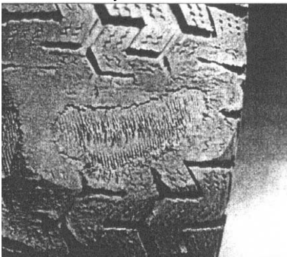
Rys 2.07. Starcie bieżnika w czasie hamowania
