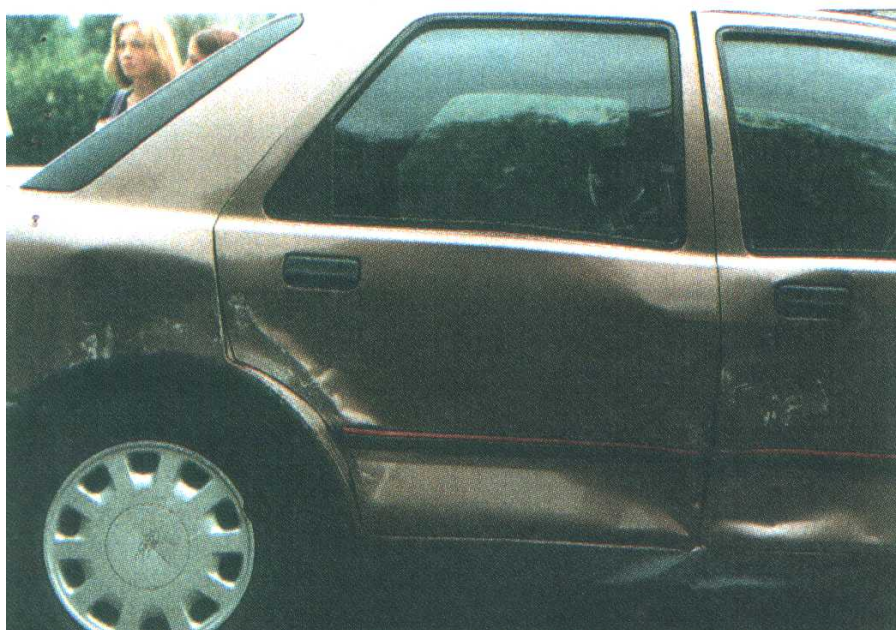
Fot. 10. Uszkodzenia prawego boku samochodu Ford ze śladami przeszczepienia białego lakieru.
