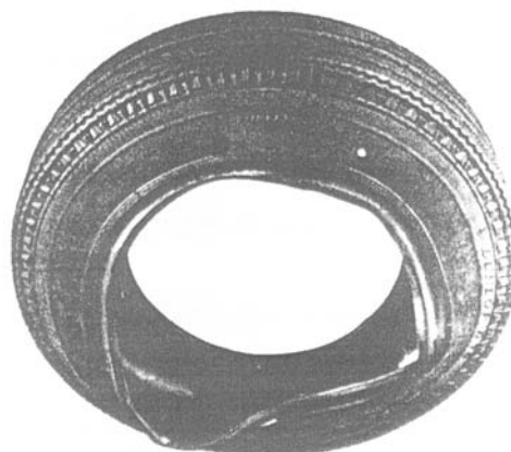
Rys 2.11. Uszkodzenie opony i jej stopki na skutek pompowania do zbyt dużego ciśnienia
