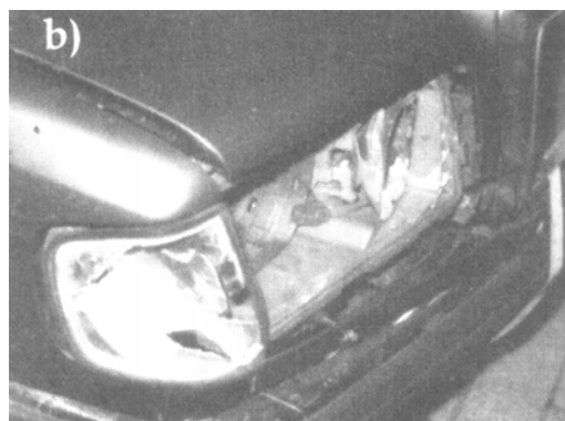
Rys 13.03. Uszkodzenie prawego przedniego narożnika samochodu Mercedes
