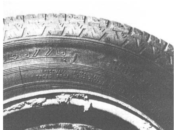
Rys 2.06. Ślady obwodowe powstałe w czasie jazdy bez powietrza
